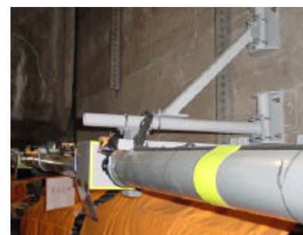
鉛直と水平変位などの2方向変位計測
