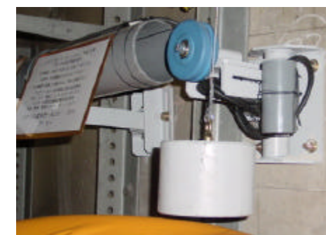
鉛直と水平変位などの2方向変位計測
