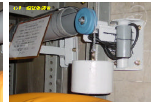
地下洞道への適用事例 (ベクトル変位計 水平変位)
