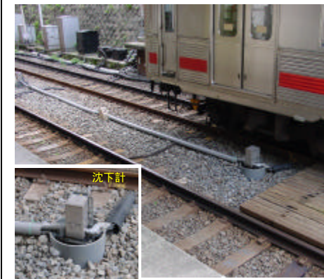
鉄道道床部への適用事例 (沈下計)
