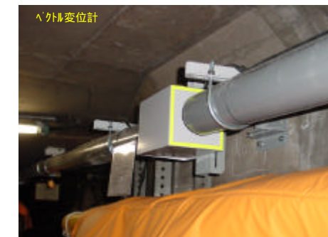
地下洞道への適用事例 (ベクトル変位計 水平変位)
