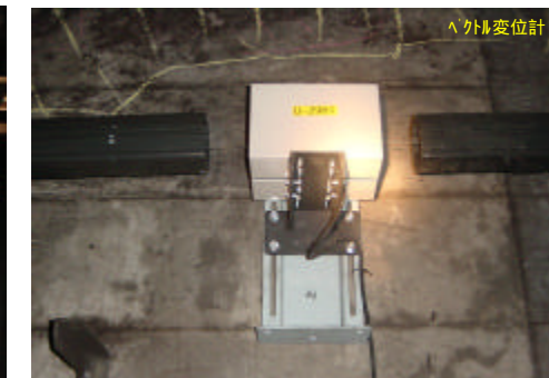
地下鉄カルパートへの適用事例 (ベクトル変位計 水平変位)
