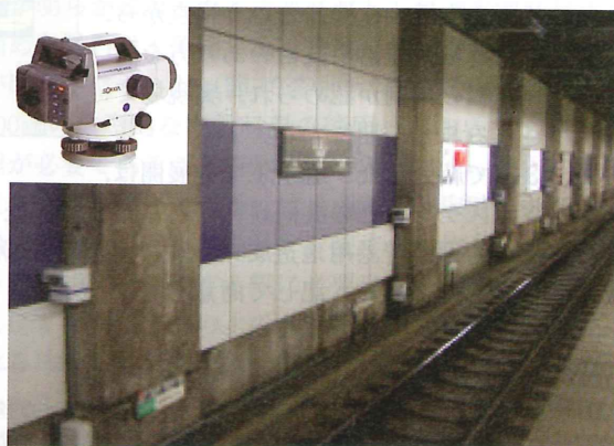
写真-2 デジタルレベルによる計測例
